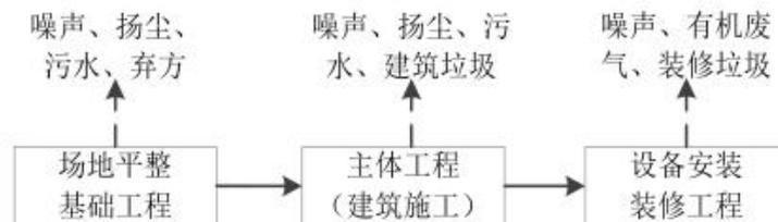
图4 项目施工期工艺流程及产污环节图
